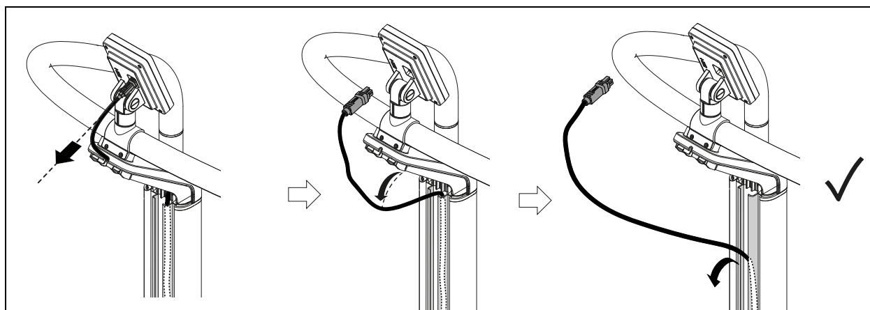
8. NUTENSTEIN FÜR OBEREN HALTER EINSETZEN • INSERTING SLIDING BLOCK FOR UPPER BRACKET • INSÉRER UN ÉCROU EN T POUR LE SUPPORT SUPÉRIEUR • INSERTAR EL TACO GUIADO PARA EL SOPORTE SUPERIOR
