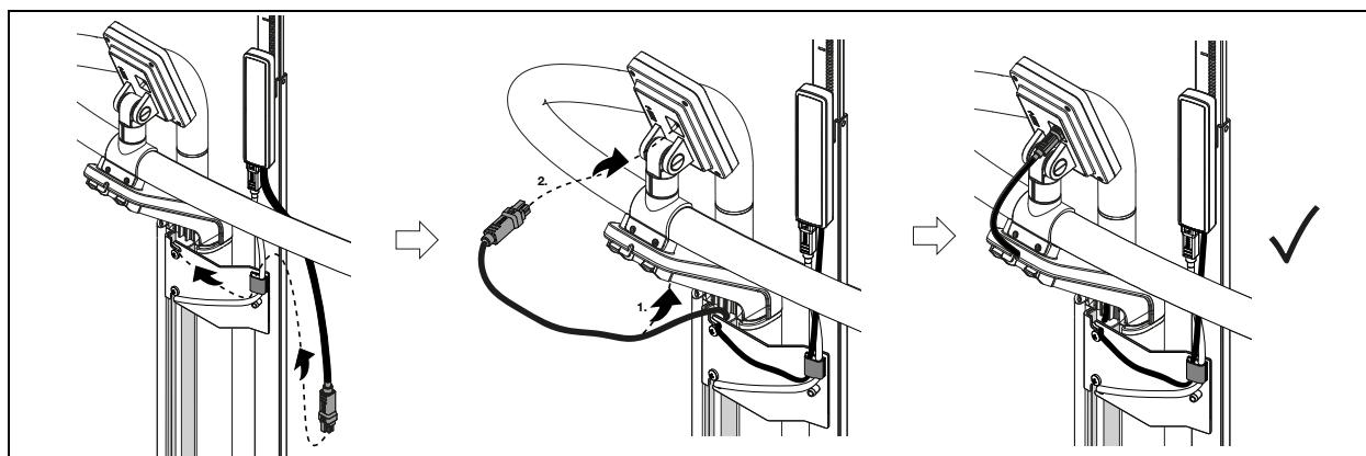
**17. ABDECKUNG RELINGVERBINDER AUFSETZEN • PLACING COVER OF HANDRAIL CONNECTOR • APOSITIONNER LE CACHE DE L'ÉLÉMENT DE LIAISON DU GARDE-CORPS • COLOCAR LA CUBIERTA DE LA CONEXIÓN DE BARANDILLA**
