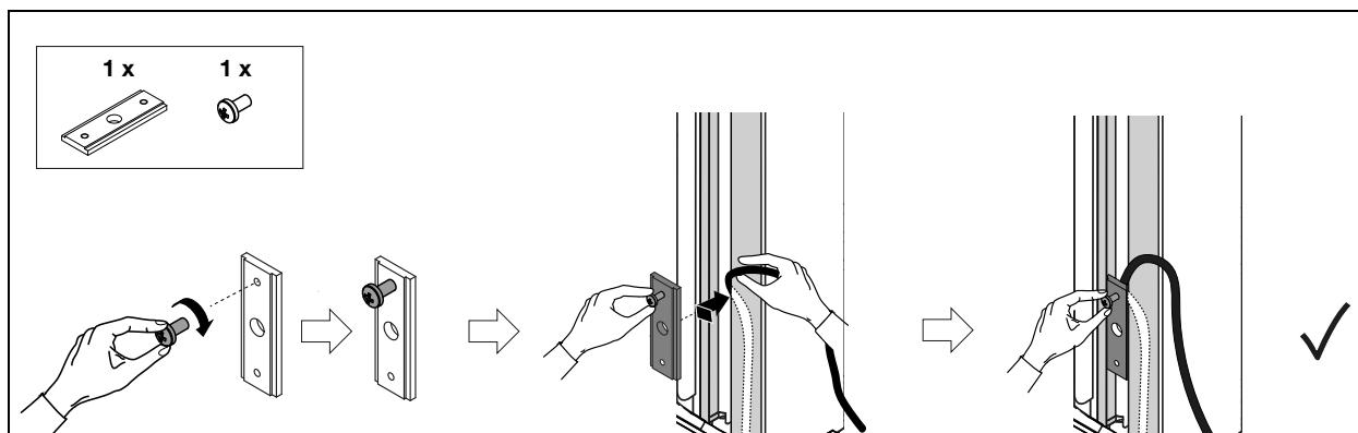
**12. UNTEREN HALTER MONTIEREN • MOUNTING LOWER BRACKET • MONTER LE SUPPORT INFÉRIEUR •
