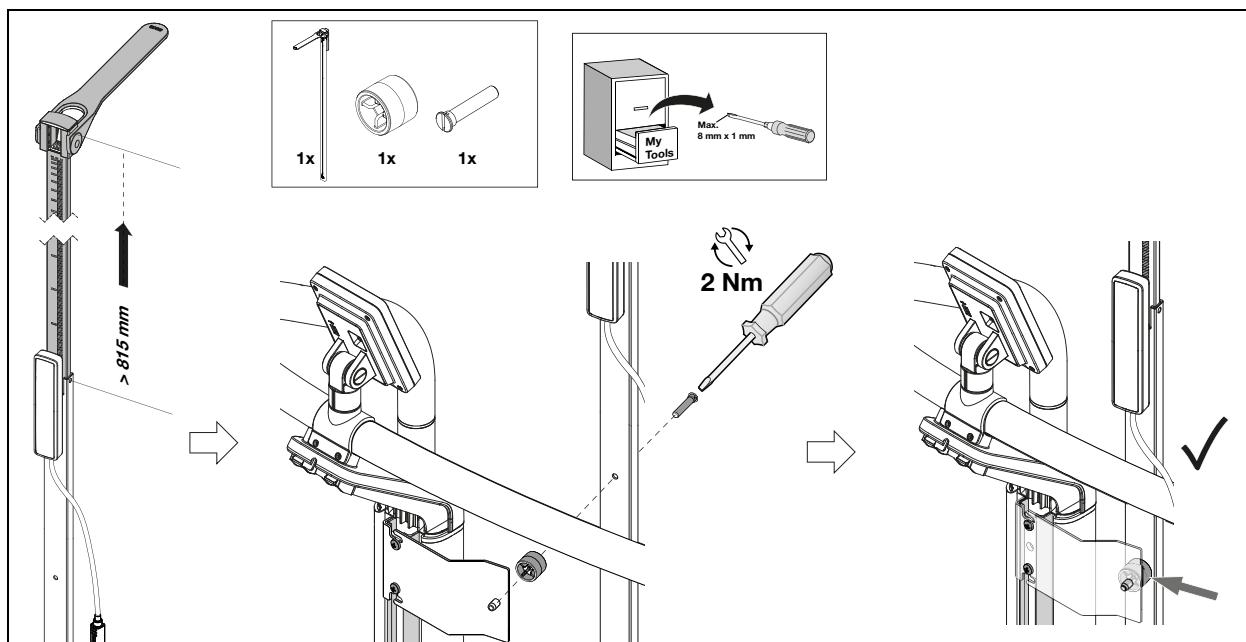
**11. NUTENSTEIN FÜR UNTEREN HALTER EINSETZEN • INSERTING SLIDING BLOCK FOR LOWER BRACKET •
