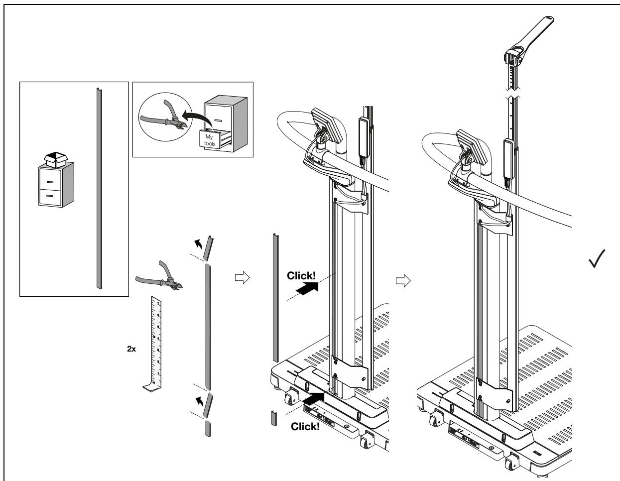
**19. VOR INBETRIEBNAHME • PRIOR TO OPERATION • AVANT LA MISE EN SERVICE • ANTES DE LA PUESTA EN MARCHA**
