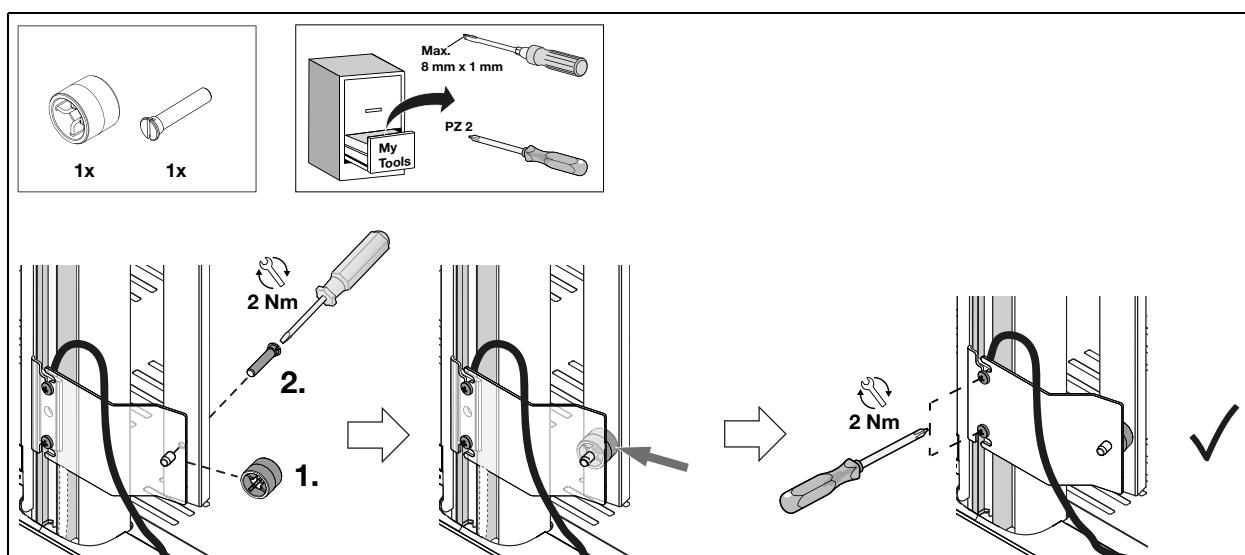
14. KABELCLIP ANBRINGEN • PLACING CABLE CLIP • POSER LE COLLIER DE CÂBLES • COLOCAR EL CLIP PARA CABLES
