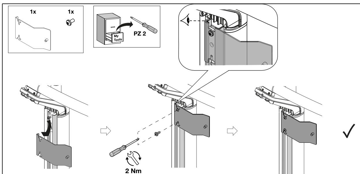
10. LÄNGENMESSSTAB AN OBEREN HALTER MONTIEREN • MOUNTING MEASURING ROD TO UPPER BRACKET • MONTER LA TOISE DE MESURE SUR LE SUPPORT SUPÉRIEUR • MONTAR EL TALLÍMETRO EN EL SOPORTE SUPERIOR
