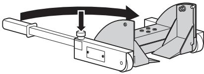
**Distribua os cabos de forma a que não toquem nas partes ilustradas a cinzento na figura.**
